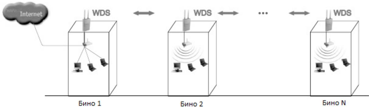
б-расм. "Шина" турдаги топология
