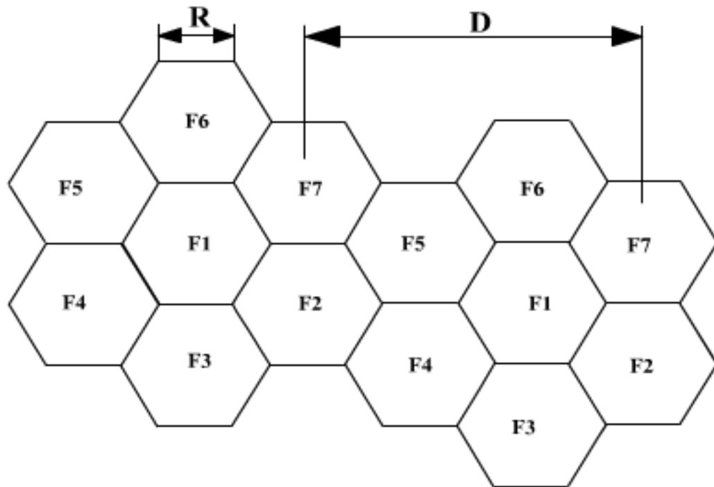
1-расм. 7 та сота учун частотани тақорий ишлатиш модели
