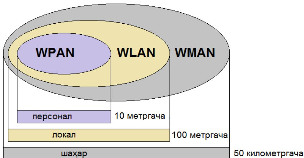
4.5-расм. Алоқанинг узатиш бўйича симсиз технологияларнинг синфларга бўлиниши
