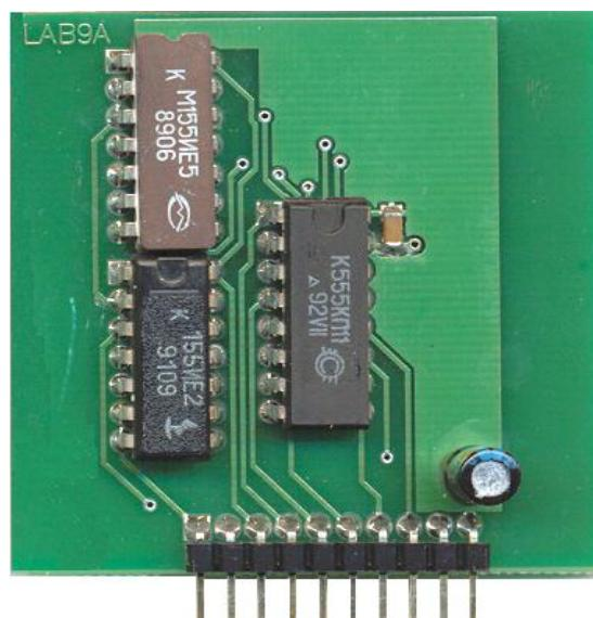
4.15 – расм. Счетчиклар ишини тадқиқ этишда қўлланиладиган **Lab9A** модулининг ташқи кўриниши.
