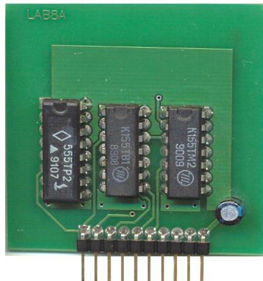
4.6 – расм. Триггерлар ишини тадқиқ этишда қўлланиладиган **Lab8A** модулининг ташқи кўриниши.
