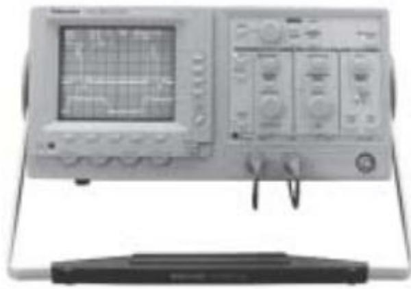
1.2 –расм. Икки каналли рақамли осцилограф.
